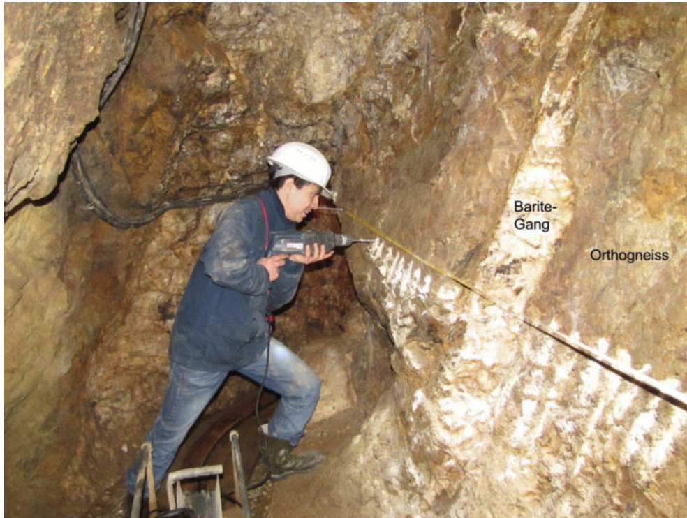
Bohrungen für Stromelektroden; Jonathan (Moll)
