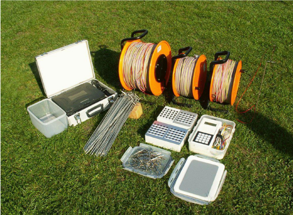
Manuelle Messanlage: Eigenbau von Schülern: Serielle Kabel 370m, 75 Edelstahl Elektroden, Steckbox; Leihgabe Fa. Lippmann: Messgerät 4-Punkt Light: max. Sendestrom 50 mAmp; (Moll)
