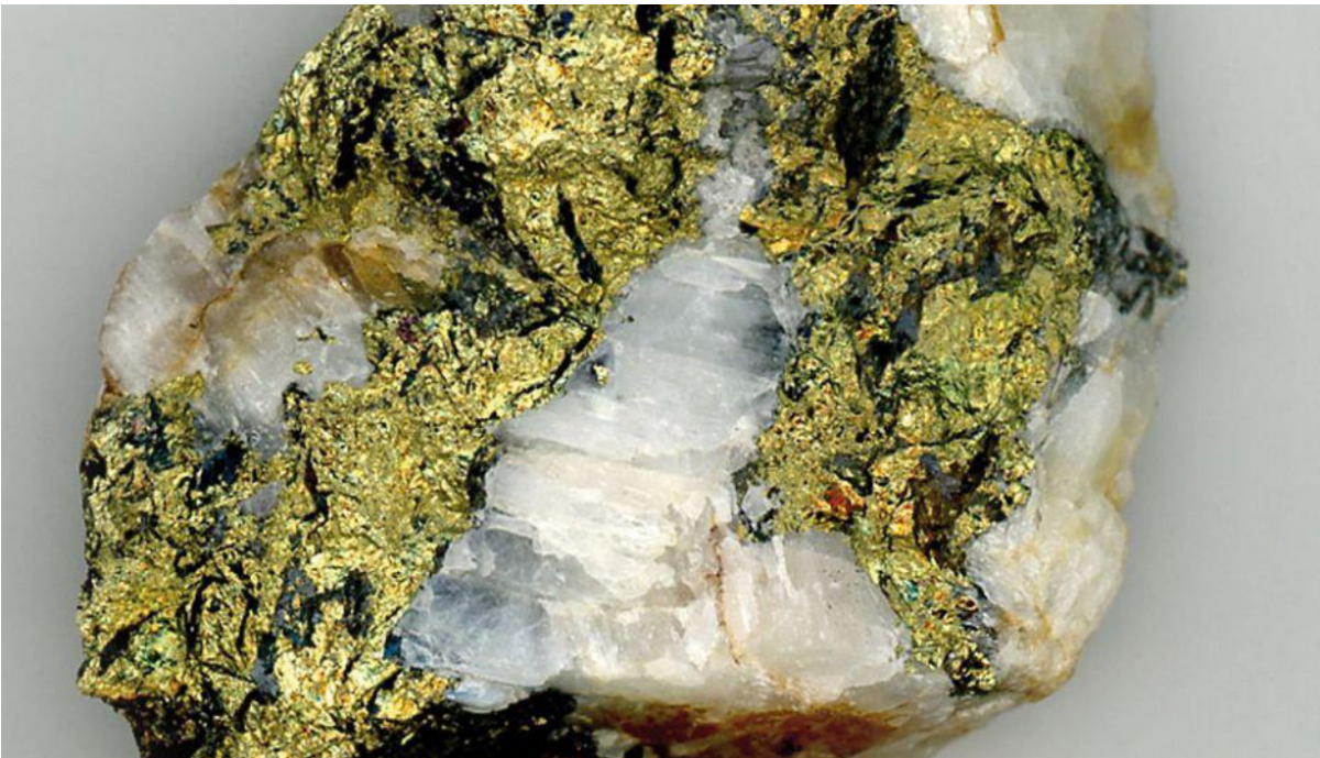
Quarz-Sulfid-Erz aus dem Suggentaler Silberbergwerk – Quarz mit Pyrit und Chalcopyrit. ( Bergwerks-Website )
